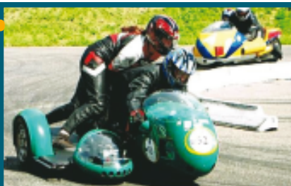
Typ: Wandel BMW Kneeler, 998 ccm, 80 PS BAUJAHR: 1972 M ORT: Peiting Barnsteiner, Franz D Barnsteiner, Johannes D
